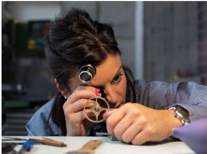
Christophe Florian, Nettoyage d'une ancienne soudure exécutée sur une roue de pendule
