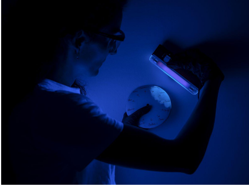
Christophe Florian, Recherche et observation au moyen d'une lampe U.V. d'anciennes restaurations sur le cadran d'une pendule du XVIIIe siècle / 2020, Ryma Hatahet, restauratrice du patrimoine métallique, mécanique et horloger / Besançon (France) / Tirage pigmentaire sur papier Fine Art contrecollé sur aluminium / 70x95 cm
