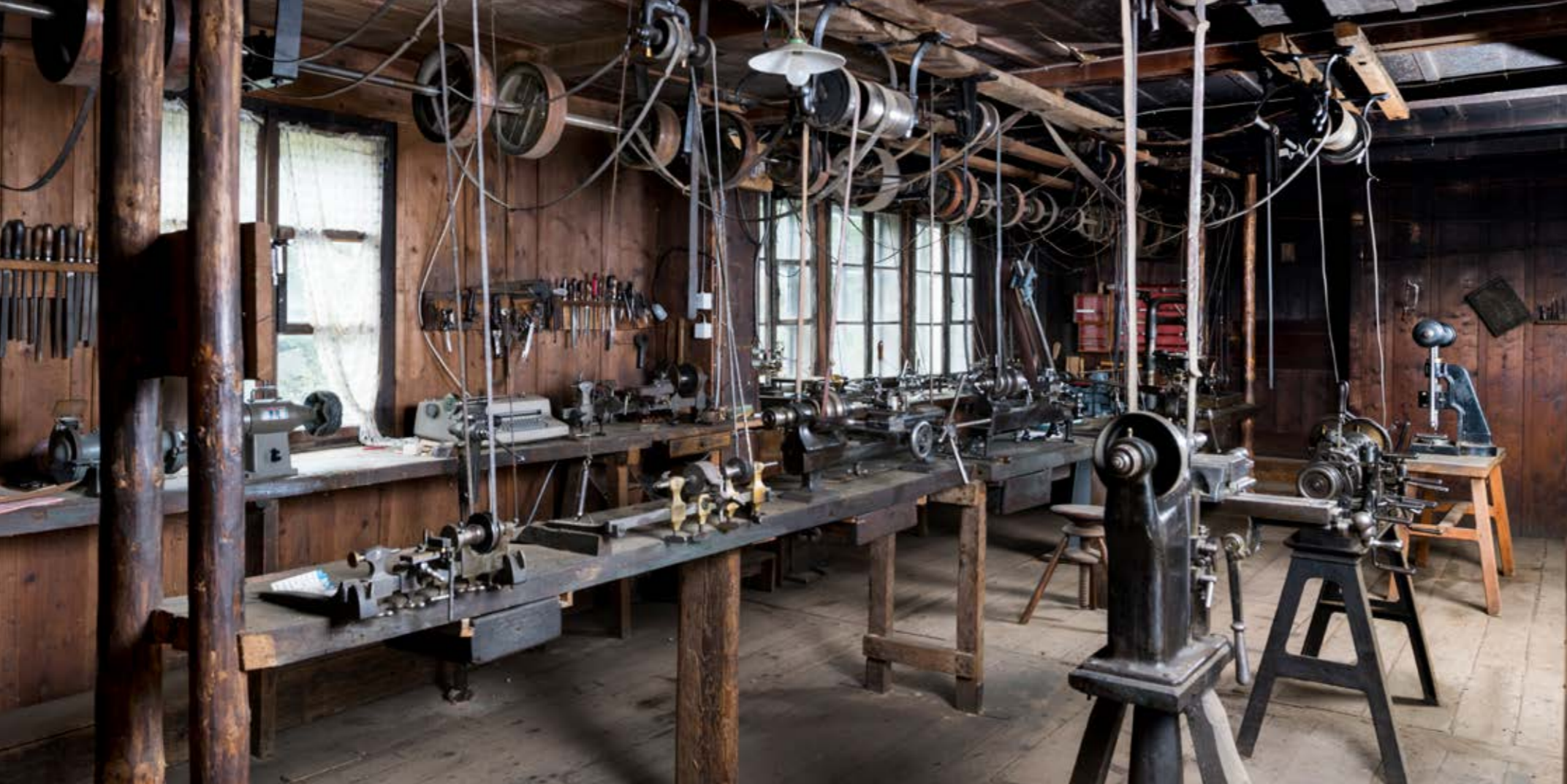
Un atelier d'horlogerie aux Gras et son système de transmission au plafond (avec poulies et courroies)
