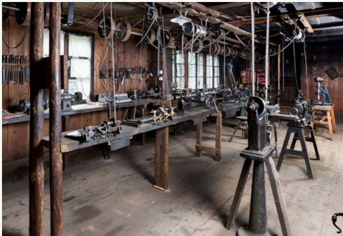
Un atelier d'horlogerie aux Gras et son système de transmission au plafond (avec poulies et courroies) © Région Bourgogne-Franche-Comté, Inventaire et Patrimoine, ADAGP, Sonia Dourlot
