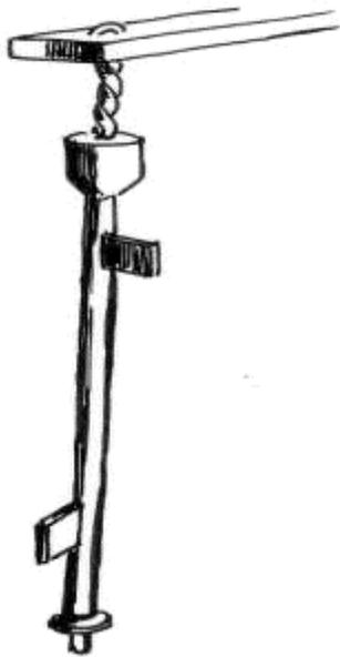
Un détail manque souvent dans la description du foliot traditionnel, c'est son fil de fixation. Pièce importante du mécanisme qui en se torsadant, offrira un couple de torsion et provoquera un mouvement de rotation en sens contraire puis se torsadant de nouveau dans l'autre sens provoquera indéfiniment un mouvement de rotation alternatif.
