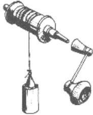
2. La masse met sous tension l'ensemble des engrenages
